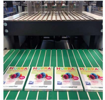
Ausführen der Stapel via Transportband. Schnittstelle zu Folgemaschine oder Entnahme von Hand
