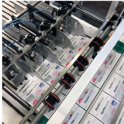
Geführter Produkttransport in den Sammelschacht. Bis zu 5 Nutzen
