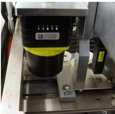
Die von der Kamera ermittelten Differenzen werden an die Steuerung übertragen.
