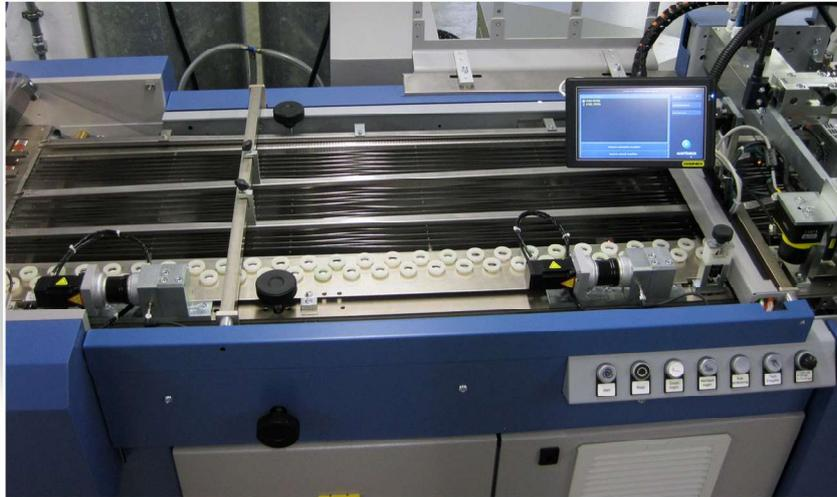
Das Kamerasystem misst die Abstände zwischen Bogenrand und Druckmarke auf jedem einzelnen Bogen aus. Das Dynamische Seitenlinal korrigiert diese ermittelten Differenzen.
