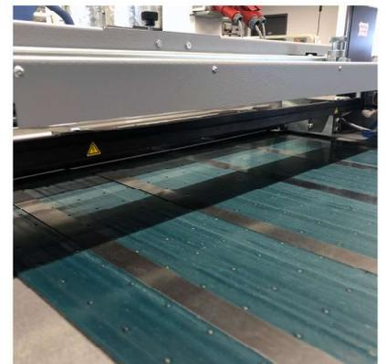
Entladungselektroden am Magnetzylinder und vor der Ausbrechstation
