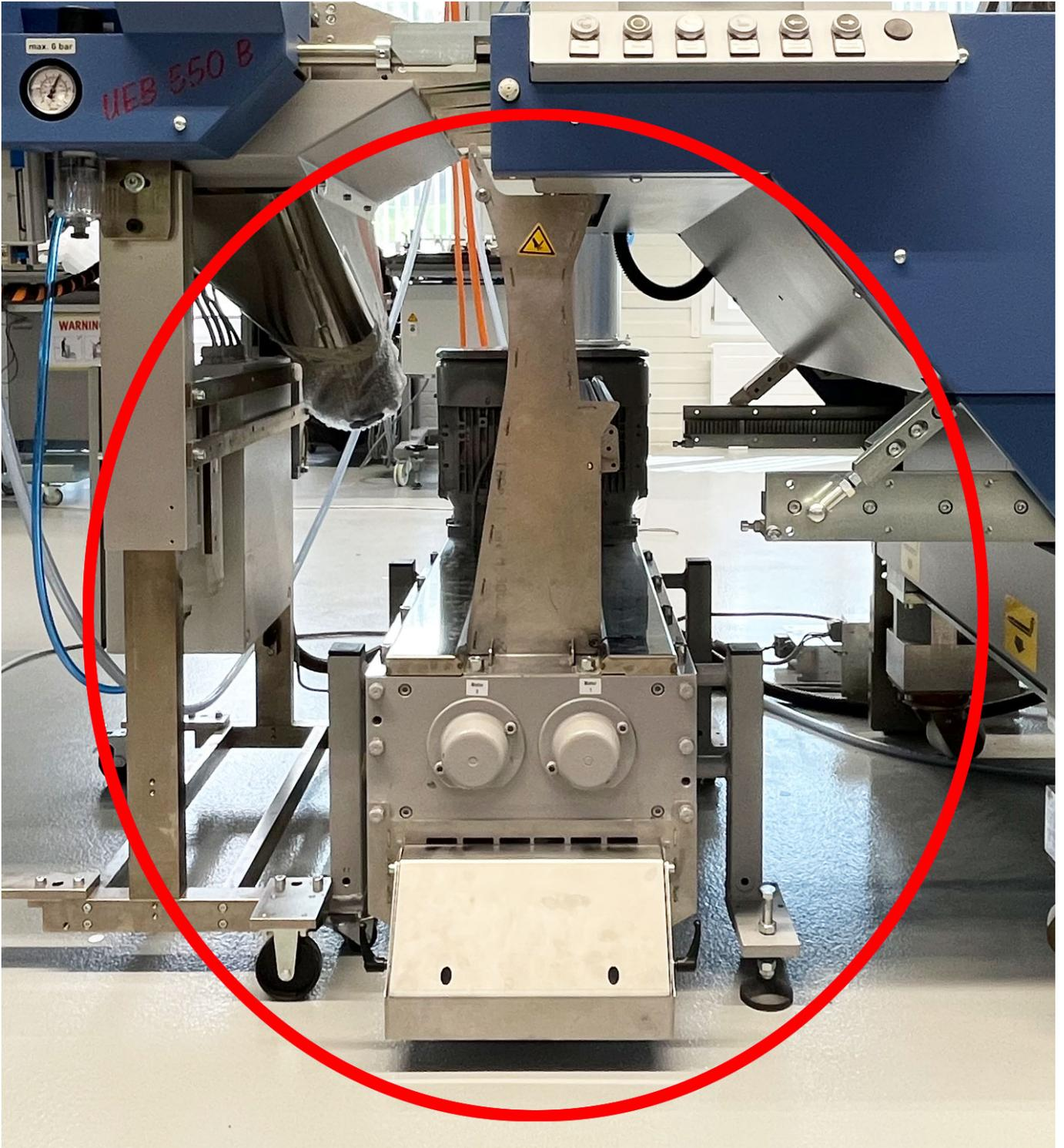
Stanzgitterzerkleinerer für rotative Stanzmaschine BSR 550 Servo mit Flachstapel- oder Palettenanleger.
