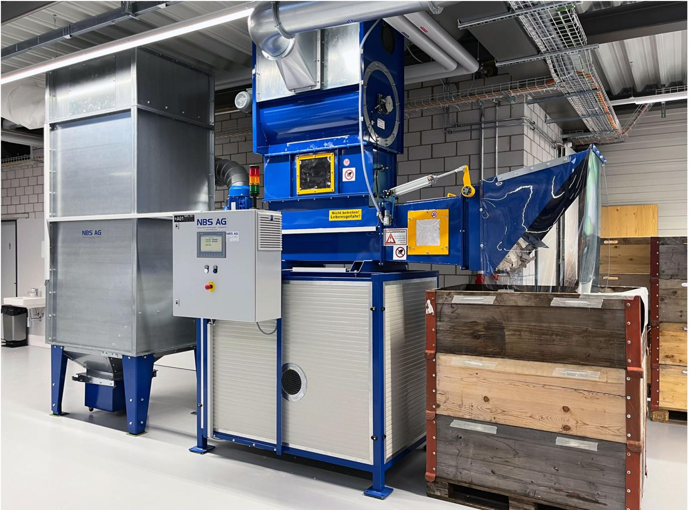
Absauganlage für Papierabschnitte und Staub. Die staubhaltige Luft wird in der Filteranlage vom Staub befreit und in die Produktionsräume zurückgeführt.
