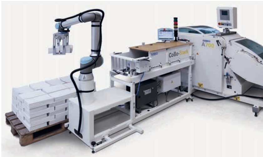
Während der »Alliance Days« zeigt MBO, wie mit Hilfe des CoBo-Stacks zwei Falzmaschinen von nur einem Anwender zeitgleich bedient werden können.
