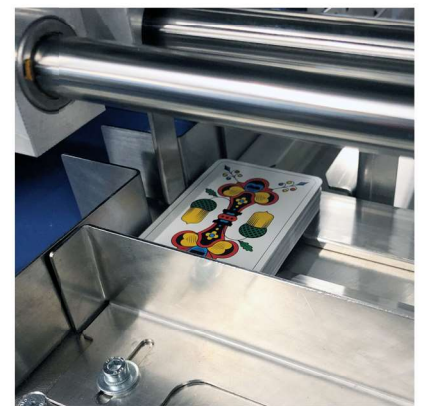
Übergabe an nachgelagerte Aggregate wie Cellophanier-, Banderolier- oder Verpackungsmaschinen
