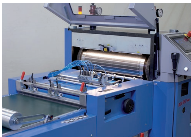
Werkzeuglos verstellbares Ausbrechsystem mit Schuppenauslage
