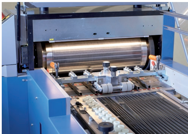
Positionierwalzen für die Bogenausrichtung in Produktionsrichtung
