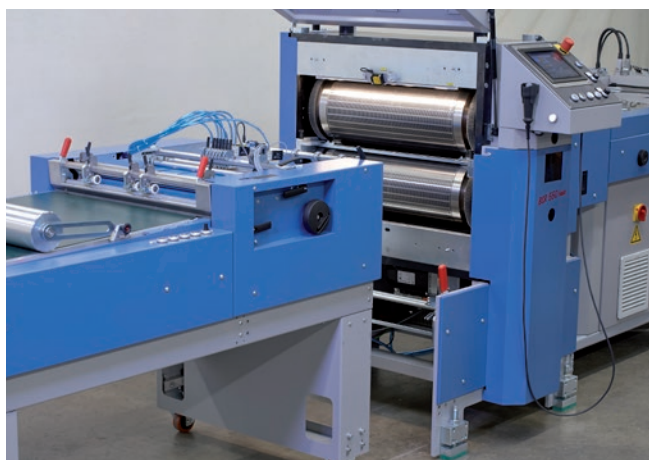
Magnetzylinder oben und unten, zur Aufnahme der Stanzbleche
